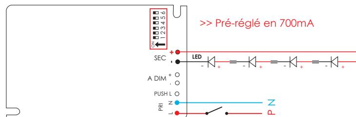
Raccorder vos spots en série sur l'entrée secondaire du convertisseur (SEC + et -), puis raccorder le Neutre (N) et la Phase (L), l'interrupteur ouvre le circuit de la Phase.
