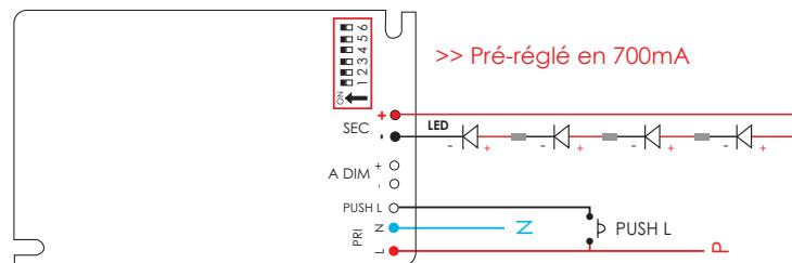
Raccorder vos spots en série sur l'entrée secondaire du convertisseur (SEC + et -), puis raccorder le Neutre (N) et la Phase (L).
