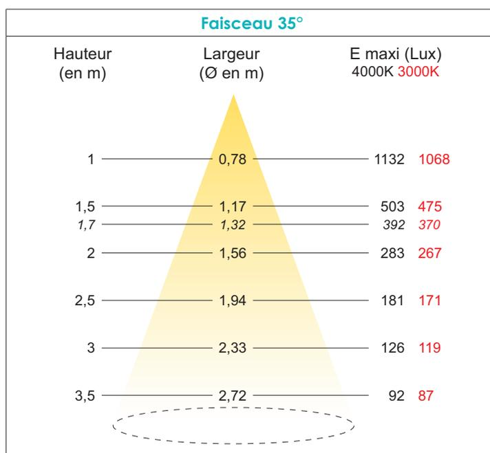
Un encastré LUNAIRE 35° éclairera un diamètre au sol de 1.62m à 2.5 mètres sous plafond et donnera 160 LUX.
