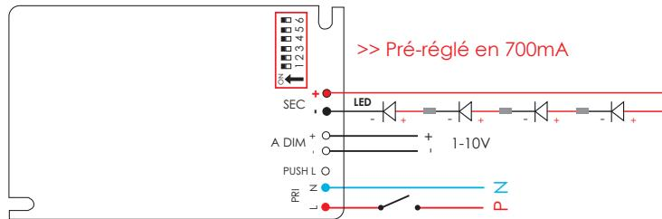
Raccorder vos spots en série sur l'entrée secondaire du convertisseur (SEC + et -), raccorder votre commande DALI entre les 2 entrées A DIM puis raccorder le Neutre (N) et la Phase (L).
