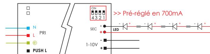
Raccorder vos spots en série sur l'entrée secondaire du convertisseur (SEC + et -), puis raccorder votre commande/passerelle 1-10V sur l'entrée 1-10V entre le - et le +
