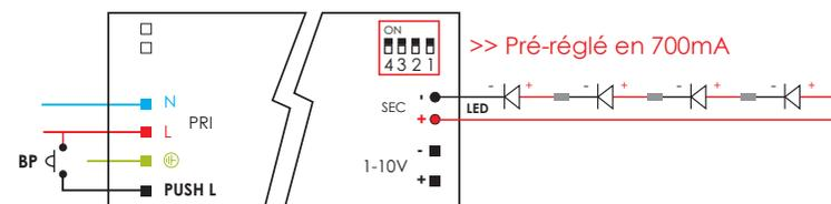
Raccorder vos spots en série sur l'entrée secondaire du convertisseur (SEC + et -), puis raccorder le Neutre (N), la Phase (L) et la Terre (T).
