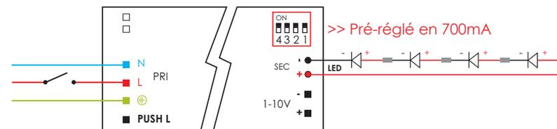
Raccorder vos spots en série sur l'entrée secondaire du convertisseur (SEC + et -), puis raccorder le Neutre (N), la Phase (L) et la Terre (T), l'interrupteur ouvre le circuit de la Phase.
