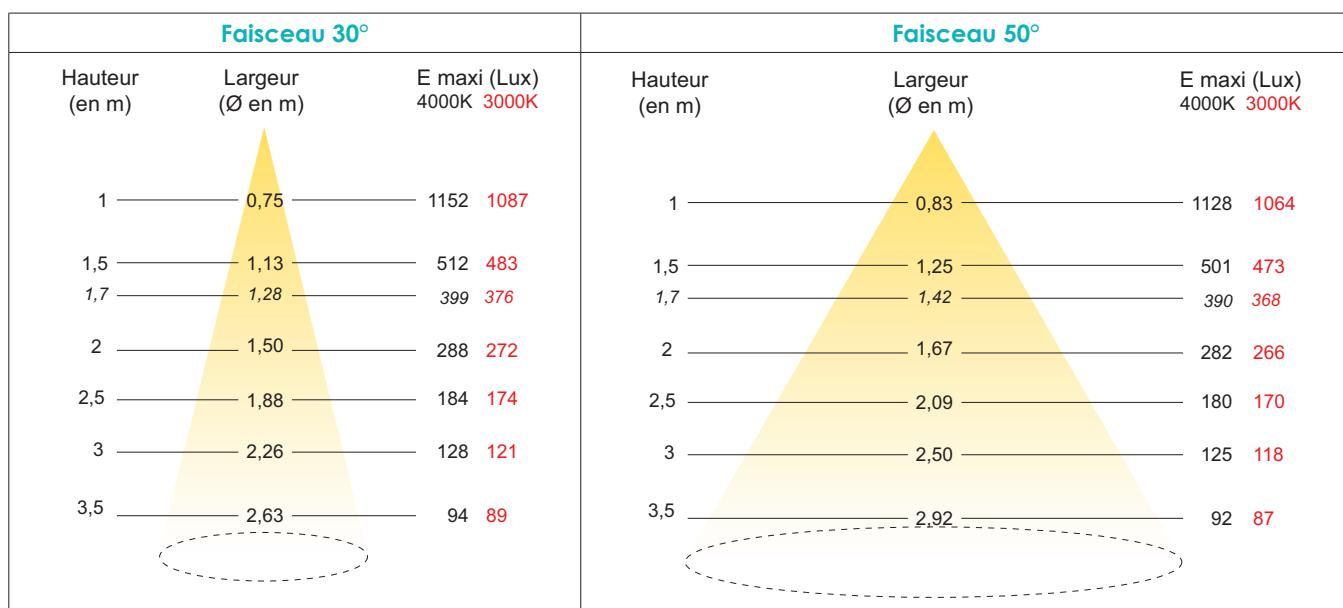
Un encastré VÉRONÈZE 30° éclairera un diamètre au sol de 1.34m à 2.5 mètres sous plafond et donnera 184 LUX, alors que le même encastré en faisceau 50° éclairera un diamètre de 2.02m au sol pour un nombre de LUX égal à 133.
