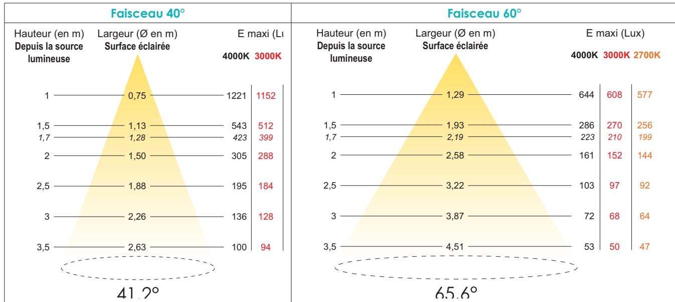
Un spot apparent sur une rampe MASTIC en 40° éclairera un diamètre au sol de 2.02m à 2.5 mètres de distance et donnera 151 LUX, alors que le même spot en faisceau 60° éclairera un diamètre de 2.89m pour un nombre de LUX égal à 95.
