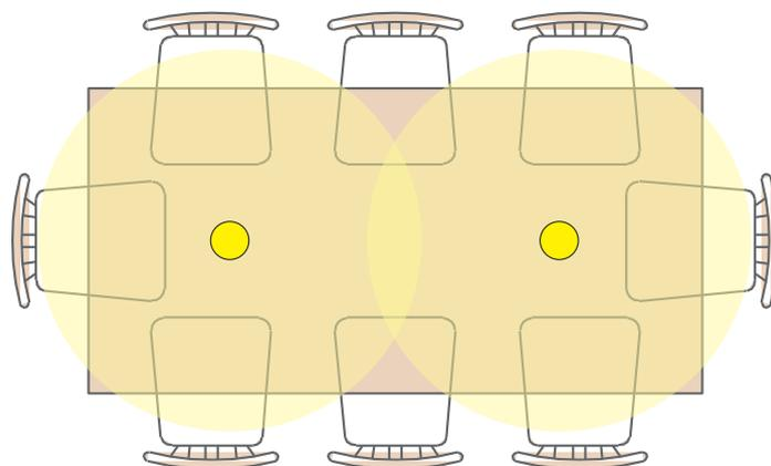
Si vous recherchez **un peu plus d'intensité** sur votre plan utile, **rapprochez un peu vos spots les uns des autres.** Lorsque les faisceaux se superposent, le nombre de lux s'aditionne et votre intensité augmente sur la surface éclairée.
