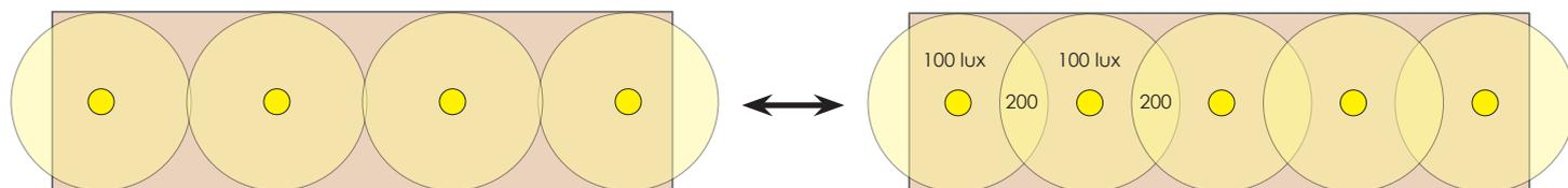
Pour les **espacements entre spots**, il faudra **espacer vos spots du diamètre trouvé sur la courbe** en fonction de la distance entre votre plafond et le plan utile à éclairer.
