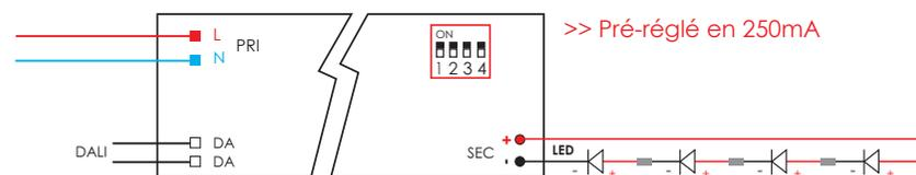
Raccorder vos spots en série sur l'entrée secondaire du convertisseur (SEC + et -), puis raccorder votre commande DALI entre les 2 entrées DA
