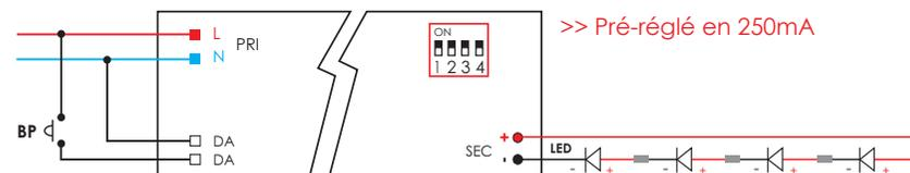
Raccorder vos spots en série sur l'entrée secondaire du convertisseur (SEC + et -), puis raccorder le Neutre (N) et la Phase (L).
