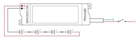
Raccorder vos spots en série sur l'entrée secondaire du convertisseur (fil rouge + et fil noir -), puis raccorder le Neutre (N) et la Phase (L), l'interrupteur ouvre le circuit de la Phase.
