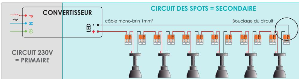
**Attention à la polarité des spots,** la sortie (+) correspond au fil rouge et la sortie (-) au fil noir. Le raccordement se fait comme sur le schéma ci-dessus : sortie (+) du convertisseur vers le fil rouge du premier spot, le fil noir du premier spot vers le fil rouge du suivant etc... jusqu'au retour du câble (-) du dernier spot au convertisseur.
