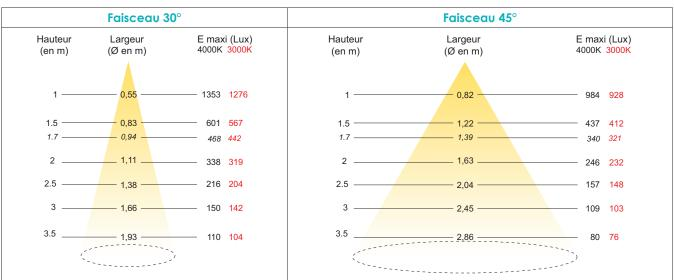
Un encastré COMPACT 30° éclairera un diamètre au sol de 1.34m à 2.5 mètres sous plafond et donnera 184 LUX, alors que le même encastré en faisceau 45° éclairera un diamètre de 2.02m au sol pour un nombre de LUX égal à 133.
