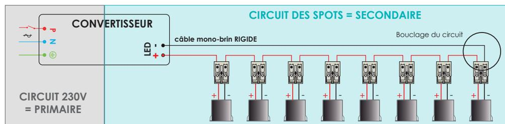
**Attention à la polarité des spots**, la sortie (+) correspond au fil rouge et la sortie (-) au fil noir. Le raccordement se fait comme sur le schéma ci-dessus : sortie (+) du convertisseur vers le fil rouge du premier spot, le fil noir du premier spot vers le fil rouge du suivant etc... jusqu'au retour du câble (-) du dernier spot au convertisseur.
