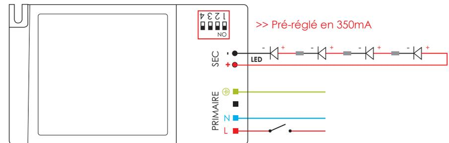
Raccorder vos spots en série sur l'entrée secondaire du convertisseur (SEC + et -), puis raccorder le Neutre (N), la Phase (L) et la Terre (T), l'interrupteur ouvre le circuit de la Phase.
