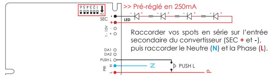
Le Bouton Poussoir filaire se raccorde entre la Phase (L) et l'entrée Push (PUSH L), un appui court pour allumer et éteindre le circuit et un appui long pour faire varier l'intensité lumineuse.
