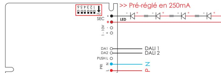
Raccorder vos spots en série sur l'entrée secondaire du convertisseur (SEC + et -), puis raccorder votre commande DALI entre les 2 entrées DA1 et DA2
