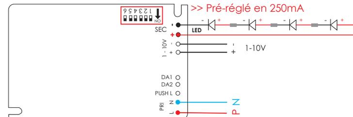
Raccorder vos spots en série sur l'entrée secondaire du convertisseur (SEC + et -), puis raccorder votre commande/passerelle 1-10V sur l'entrée 1-10V entre le - et le +
