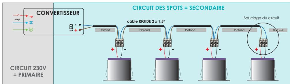
**Attention à la polarité des spots**, la sortie (+) correspond au fil rouge et la sortie (-) au fil noir. Le raccordement se fait comme sur le schéma ci-dessus : sortie (+) du convertisseur vers le fil rouge du premier spot, le fil noir du premier spot vers le fil rouge du suivant etc... jusqu'au retour du câble (-) du dernier spot au convertisseur.
