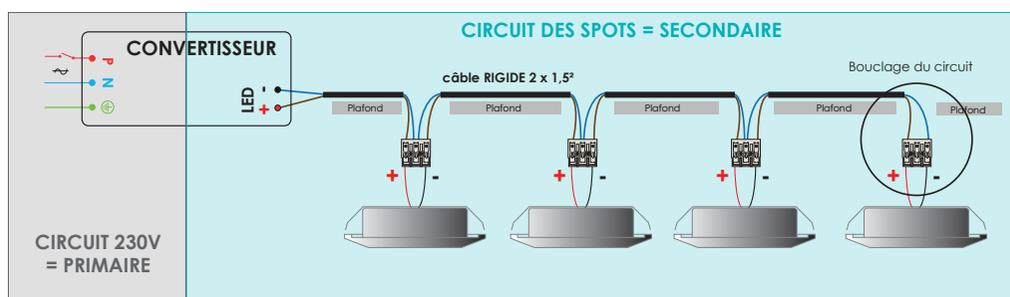
**Attention à la polarité des spots**, la sortie (+) correspond au fil rouge et la sortie (-) au fil noir. Le raccordement se fait comme sur le schéma ci-dessus : sortie (+) du convertisseur vers le fil rouge du premier spot, le fil noir du premier spot vers le fil rouge du suivant etc... jusqu'au retour du câble (-) du dernier spot au convertisseur.
