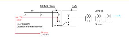
L'inter de coupure est recommandé en cas d'anomalie du télévariateur (courtcircuit ou les lampes restent allumées en permanence).
