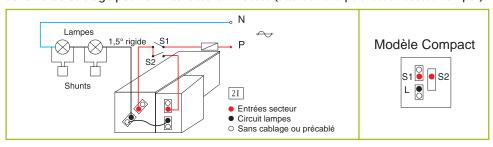
Schéma de câblage pour le 3 intensités lumineuses (attention à la polarisation secteur-lampes) :
