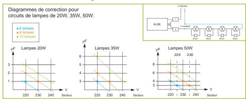
U secteur à mesurer entre pôle 1 et Neutre (le pôle 2 de transit du Neutre étant facultatif ne figure pas sur le schéma).
