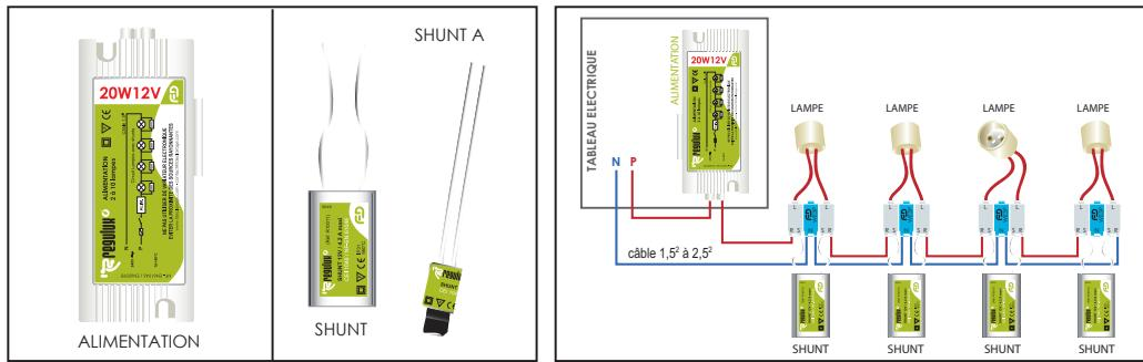
Afin que le circuit ne soit pas coupé par une lampe défectueuse, un dispositif de relai-shunt est branché en parallèle sur chaque lampe. C'est lui qui assure la protection du circuit **des lampes**, lesquelles **doivent être toutes identiques** (même puissance adaptée à l'alimentation). La dernière lampe de la série est reliée directement au neutre (bouclage du circuit).
