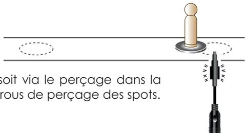
2. Enfiler l'insert aimanté dans le montant, soit via le perçage dans la faitière ou dans le chêneau, ou bien par les trous de perçage des spots.
